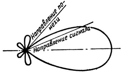
Фиг. 1.11. Увеличение отношения  $\frac{\text{сигнал}}{\text{помеха}}$  при помощи направленной приемной антенны.
