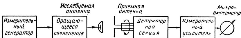
Фиг. 11. 25. Блок-схема установки для снятия поляризационной характеристики антенны.
